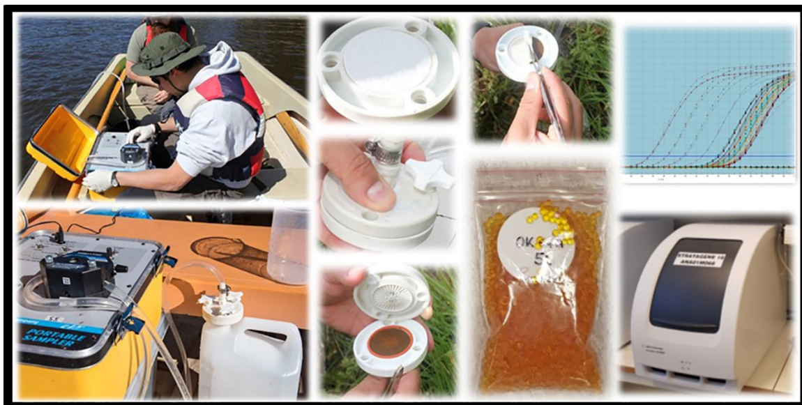
Figur 4.2. Vannprøver på ~5 liter ble filtrert på stedet ved hjelp av en portabel peristaltisk pumpe. Filterene ble overført til ziplockposer med silica gel for oppbevaring frem til analyse. DNA ble isolert med en CTAB ekstraksjonsmetode og tilstedeværelsen av eDNA fra edelkreps og signalkreps ble undersøkt med qPCR.
